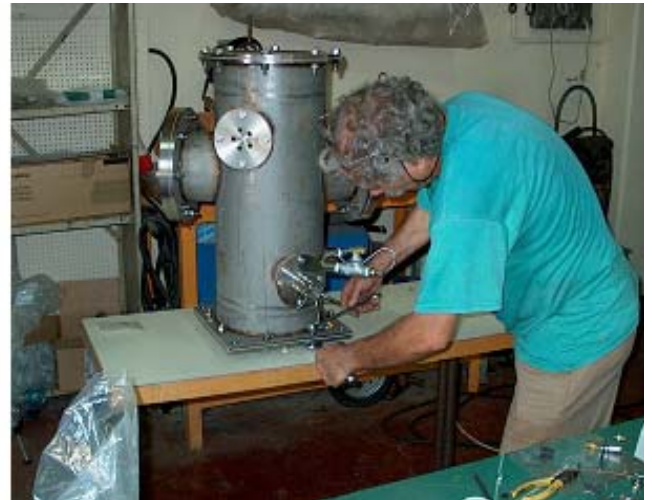
Fig 1.2 IST Test rig for hot atmospheric testing, design and actual
